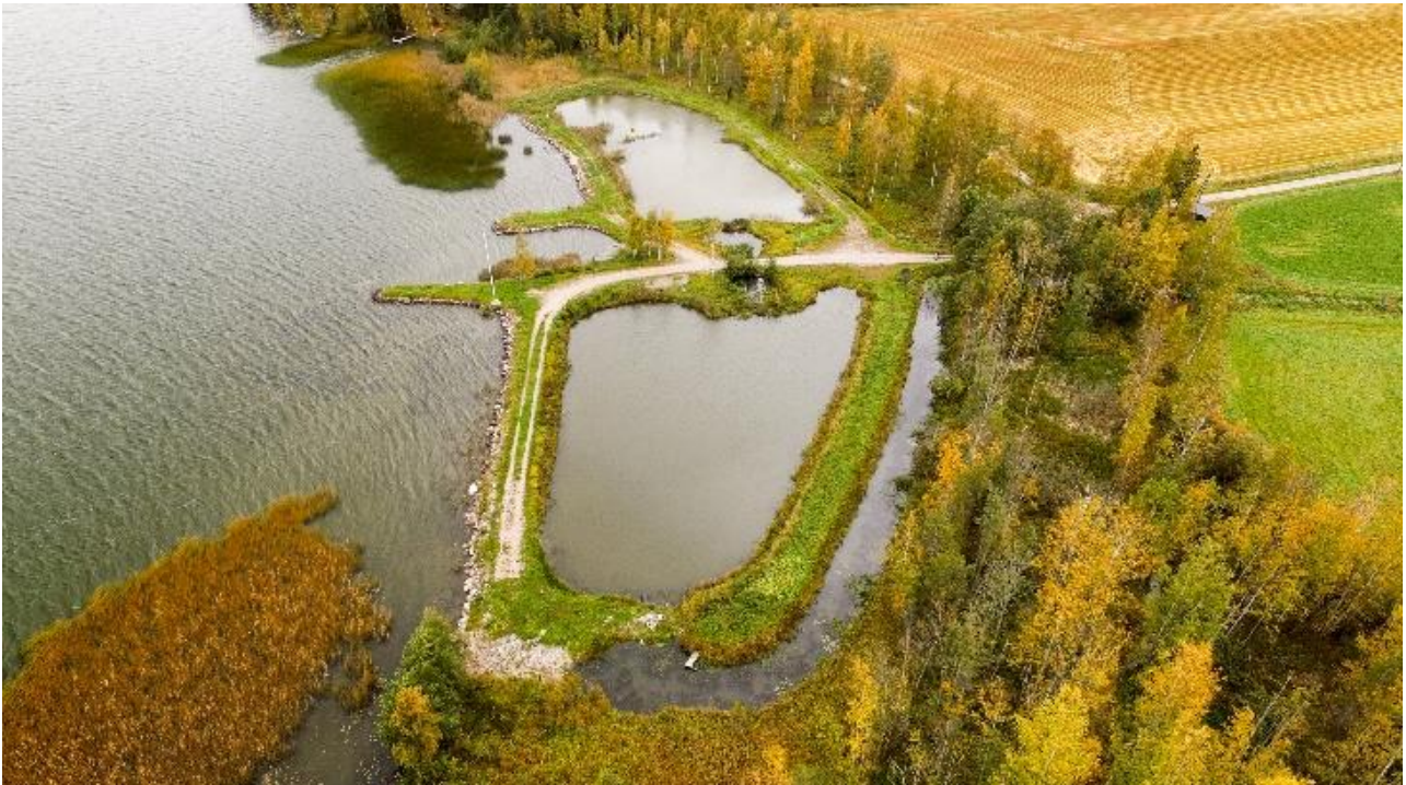
Kuva 3. Purailanviepän kosteikko. Altaan alkuosa on pitkänomainen tulouoma, josta ylivirtaamalla vesi pääsee myös järveen kuvan alaosassa näkyvän kivipadon yli. Muutoin vesi virtaa suurempien altaiden läpi ja laskee järveen kuvan yläosassa sijaitsevan lasku-uoman kautta.
