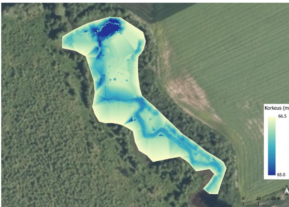
Kuva 13. Kaikuluotausaineistosta tehty Markanojan kosteikon syvyysmalli.
