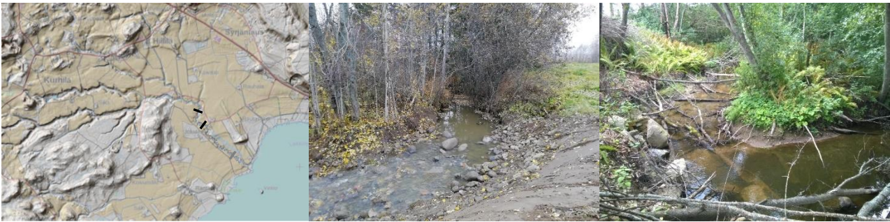
Kuva 5. Vasemmalla vinovalovarjoste Häränsilmänojan valuma-alueesta sekä uomaan suunnitellut pohjapatorakenteet. Alin pato on merkitty harmaalla, koska se jätettiin rakentamatta. Keskellä kuva ylimmäisestä pohjapadosta. Oikealla Häränsilmänojan alajuoksun vaikeaa tilannetta.
